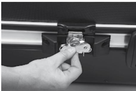
**1.2** Klappen Sie die Drehklappe auf und drehen Sie diese bis der Verschlussanker offen ist.
