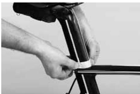
**3.4** Vor der Demontage von Sattel samt Stütze markieren Sie die Einstecktiefe der Sattelstütze mit einem Klebestreifen. Kleben Sie einen zweiten Klebestreifen an gleicher Stelle an den Rahmen und ziehen Sie einen senkrechten Strich. Dies erleichtert am Zielort die Einstellung der Sitzhöhe und die Ausrichtung des Sattels enorm.
