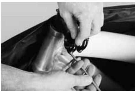
**3.3** Drehen Sie die vier Schrauben nur mit geringen Kräften an, so dass der Lenker gerade so im Vorbau klemmt bzw. die Klemmschalen leicht befestigt sind.
