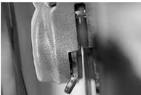
**3.4** Bei Scheibenbremsen (hydraulisch oder mechanisch) sollten Sie vorher schauen, wo die Bremsbeläge bzw. deren Verschleißindikatoren (Metallohren/-nasen) sitzen. Später können Sie daran erkennen, ob die Beläge nach der Demontage noch an der dafür vorgesehenen Stelle sind. Lesen Sie die Bedienungsanleitung des Bremsenherstellers durch.
