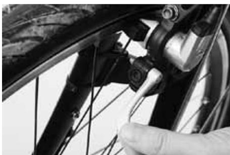
**3.3** Bei hydraulischen Felgenbremsen der Firma Magura öffnen Sie deren Schnellspannhebel auf einer Bremsseite und ziehen die Bremse vom Haltesockel.
