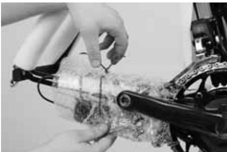
**3.4** Schützen Sie die Kettenstrebe entweder mit etwas Luftpolsterfolie oder mit Schaumstoffrohren z.B. von Warmwasserrohren. Verpacken Sie das demontierte Schaltwerk und binden Sie es mit Kupferdraht etwa in die Mitte der geschützten Strebe.
