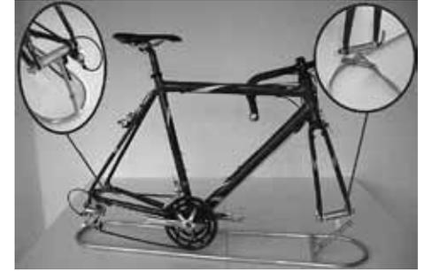
**3.6** Drehen Sie die Kurbel parallel zur Kettenstrebe und fixieren Sie das Pedalauge mit kunststoffummanteltem Draht oder einem Kabelbinder an der mit Isolationsrohr oder Luftposterfolie geschützten Kettenstrebe.
