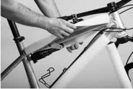
**3.1** Schützen Sie den gesamten Rahmen entweder mit Isolationsrohren oder mit Luftpolsterfolie.
