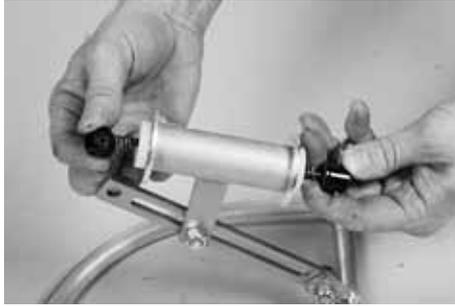
**3.1** Schieben Sie die Schnellspanner in die Aufnahmen im ASF. Führen Sie die Federn so auf die Schnellspanner, dass auf jeder Seite eine Feder ist und die dünnen Bereiche aller Federn nach innen zeigen.
