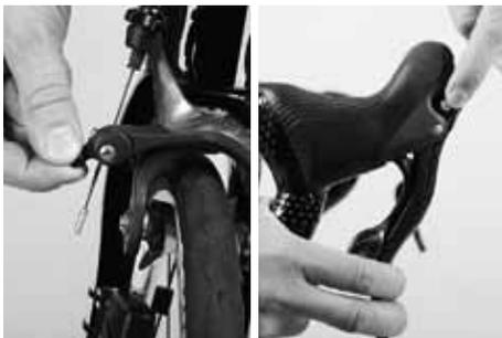
**3.1** Öffnen Sie bei Rennrädern den Entspannhebel an der Bremse (Shimano, SRAM) oder verschieben Sie den Stift im Schalt-Bremsgriff am Lenker (Campagnolo).
