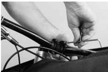
**3.1** Lösen Sie im ersten Fall die am Vorbau vorne liegenden Schrauben ein bis zwei Umdrehungen und drehen Sie den Lenker nach unten, bis die geringste mögliche Baubreite erzielt ist.
