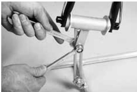
**3.4** Passt die Gabel nicht hinein, müssen Sie die Aufnahme durch Lösen und Verschieben am vorderen Ausleger anpassen.
