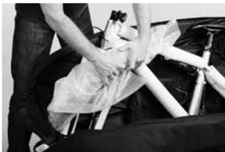
**3.2** Reicht dies nicht aus, müssen Sie den Lenker komplett demontieren. Schützen Sie den Lenker mit Luftpolsterfolie.
