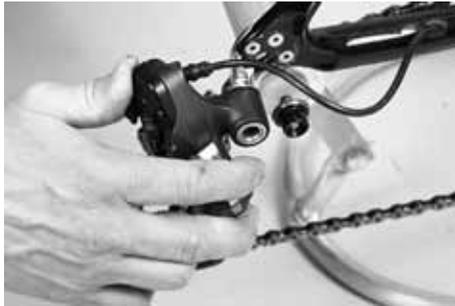
**3.2** Nehmen Sie das Fahrrad mit einer Hand hoch und ziehen Sie das Schaltwerk mit der anderen etwas nach hinten. Setzen Sie die hinteren Ausfallenden in die Aufnahme für hinten, so dass der obere Kettenbereich über der Aufnahme verläuft.
