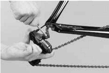
**3.3** Drehen Sie das Schaltwerk etwas nach hinten und halten Sie es mit einer Hand weiter fest, damit es durch die Federspannung nicht unkontrolliert abfällt, wenn Sie die Schraube lösen. Drehen Sie die Verschraubung ganz auf.
