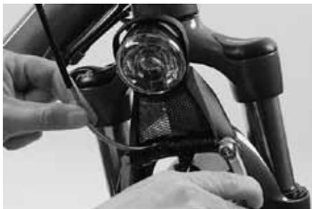
**3.2** Bei mechanischen Felgenbremsen (Cantilever- und V-Bremsen) müssen Sie zuerst den Seilzug am Bremsarm aushängen. Fassen Sie dazu mit einer Hand um die Felge und drücken Sie die Bremsbeläge bzw. die Bremsarme zusammen. In dieser Stellung lässt sich der meist tonnenförmige Nippel des Bremsquerzuges bzw. die Zughülle (bei V-Bremsen) leicht aushängen.
